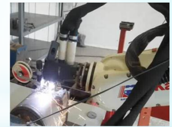
Процесс напыления проволочного покрытия на установке микроплазменного напыления МПН-004
